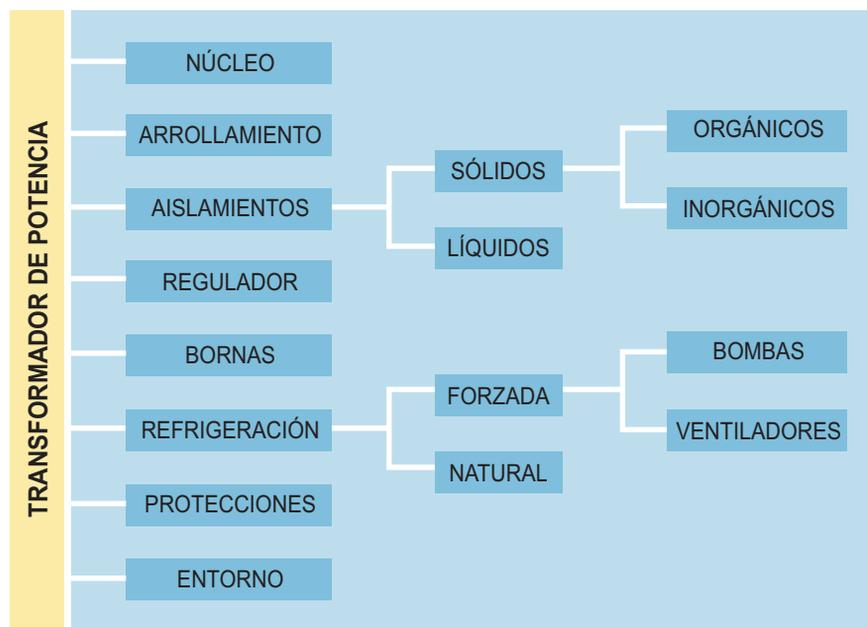
Figura 3.- Elementos básicos de un transformador de potencia.
